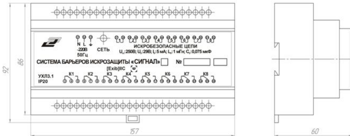
Рис.2 Габаритные размеры системы барьеров искрозащиты «Сигнал»
