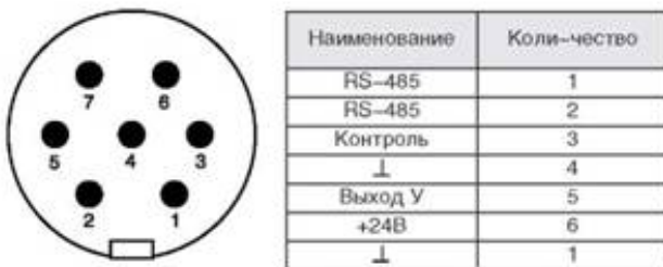
Рис. 6. Схема подключения датчика РДУ-Х2
