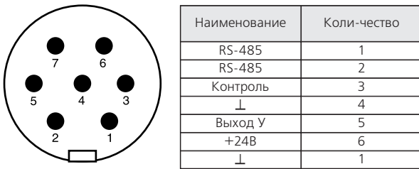
Рис. 6. Схема подключения датчика РДУ-Х2
